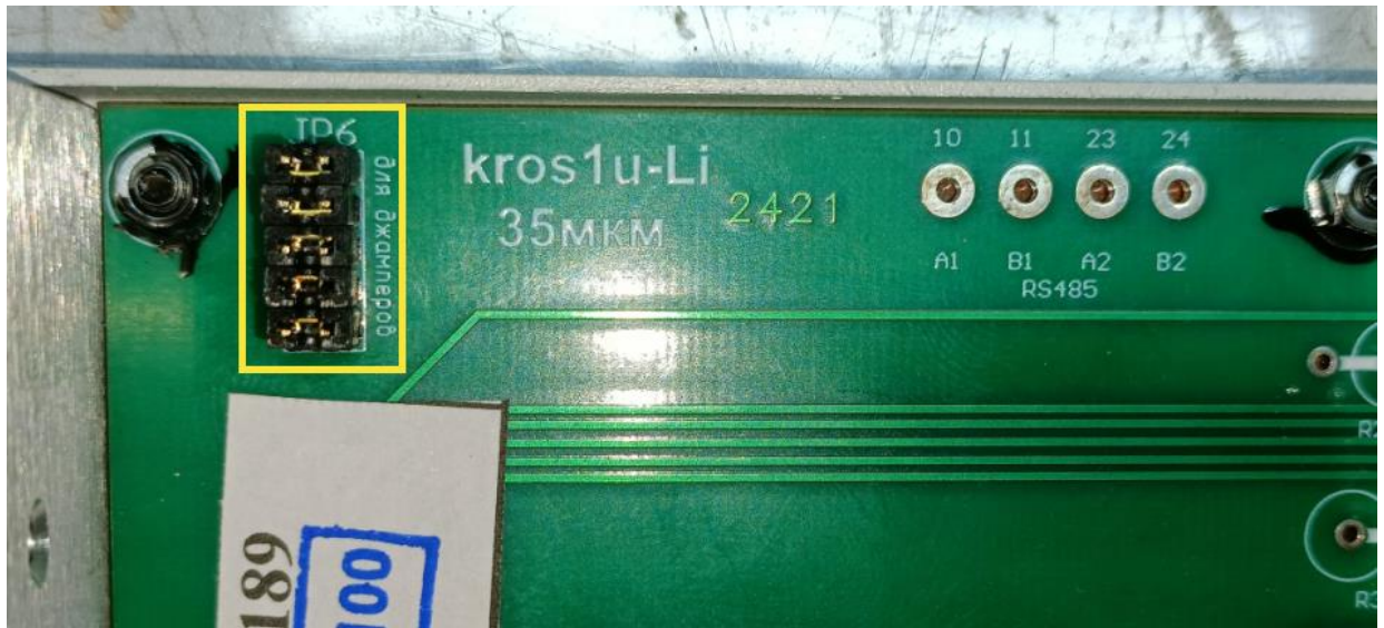
Рисунок 6.3 – Резервные джампера на кросс-плате.
